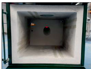
Termikusan hatékony monolit a magas minőségű tűzálló beton szigetelőanyaggal - nincs leváló téglafal.
