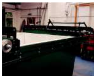
A tolóajtó nyitott állapotban a teljes szélesség eléréséhez töltésnél
