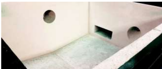
a monolit bélés maximalizálja a termikus hatékonyságot –nincs téglák ami kieshet
